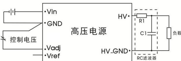
图2 输出电压外部调节方式
