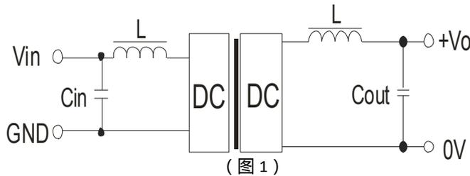
但应注意电感值的选取及“LC”滤波网络其自身的频率应与DC/DC频率错开,避免相互干扰。并选用合适的滤波电容。若电容太大,很可能造成启动问题。输出电容的选取,请参考最大输出容性负载要求。
